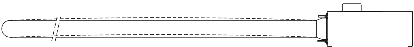
Rys. 5.2 Odkształcenie rury urządzenia podczas uruchomienia
